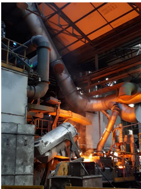
Figura 3 - Fase di colata della ghisa nel forno di attesa di H3
