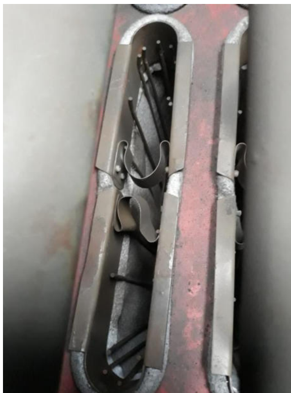
foto 1 – elementi elastici danneggiati
